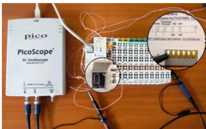
Рис. 19. Подключение осциллографа к контроллеру для получения циклограмм исполнения прикладной программы и обмена с модулями по внутренней шине
