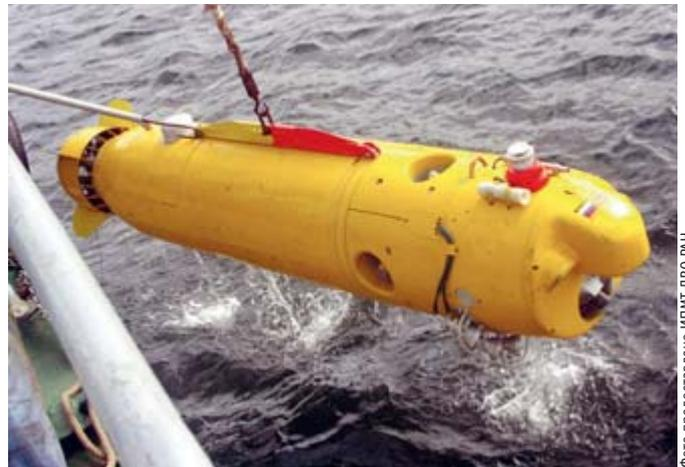
Рис. 4. Автономно-привязной подводный аппарат TSL
