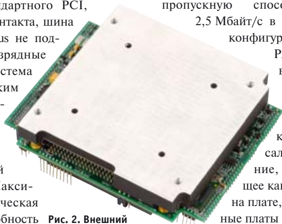
Рис. 2. Внешний вид модуля Fastwel SRC1600/1700 с установленным радиатором кондуктивного теплоотвода на внешний корпус
