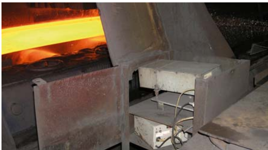
Рис. 5. Расположение оптического измерителя относительно подающего рольганга
