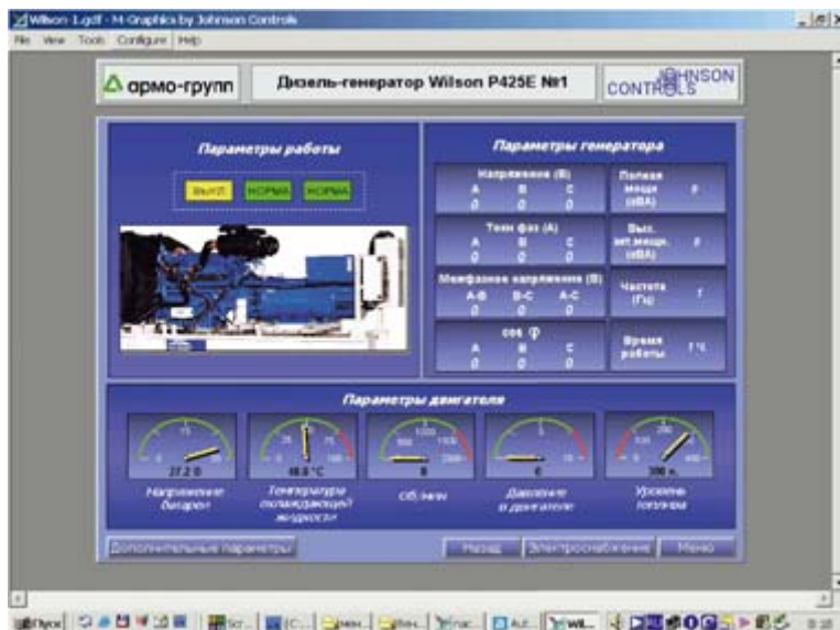
Рис. 6. Копия экрана автономной системы управления бесперебойным энергоснабжением
