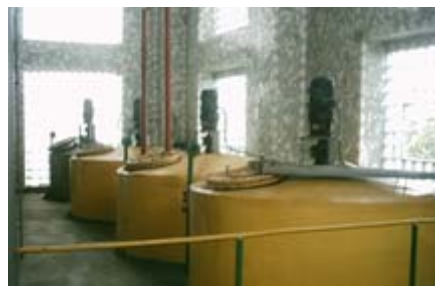
Рис. 2. Технологический участок гидроферментативной обработки крахмала (низкотемпературной варки)
