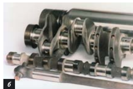
Рис. 2. Вал турбодетандера с восстановленными опорными шейками (а) и восстановленные детали автомобиля (б)
