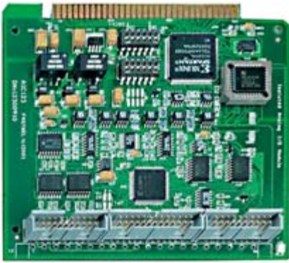
Рис. 2. Внешний вид модуля аналогового ввода-вывода AIC123, выполненного в формате MicroPC (14-разрядное АЦП, 16 каналов аналогового ввода, 2 канала аналогового вывода, 3 восьмиразрядных цифровых порта ввода-вывода)
