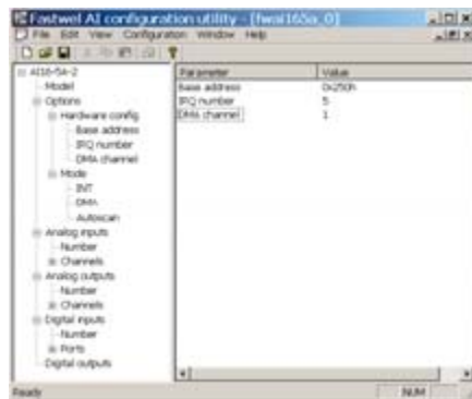
Рис. 3. FWAI CFG устанавливает параметры модуля ввода-вывода и сохраняет настройки в файл, который читается аппаратным драйвером при старте операционной системы
