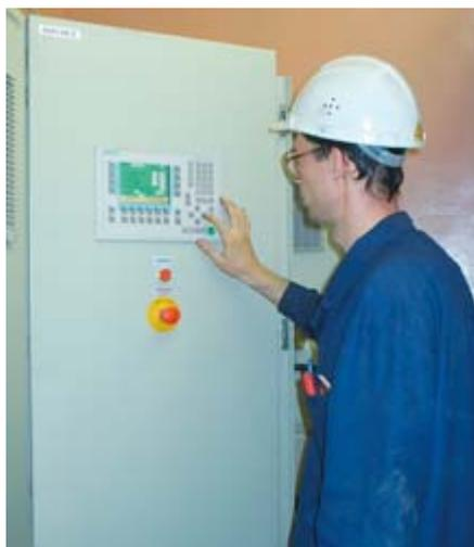
**Рис. 6. Панель оператора OP 270, расположенная на двери шкафа управления стендом сушки**
