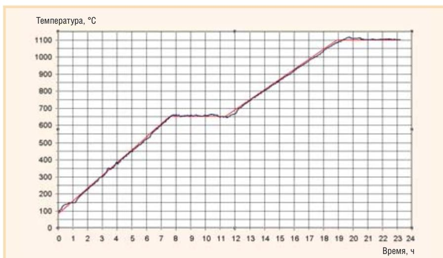
Рис. 9. График сушки сталеразливочного ковша в автоматическом режиме
