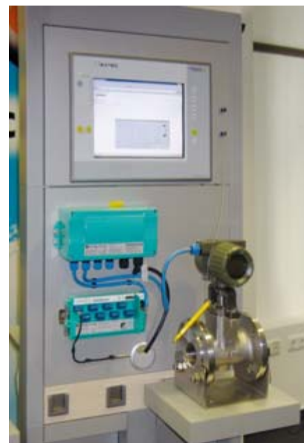
Пример использования ПК VISUEX в составе стенда тестирования датчиков
