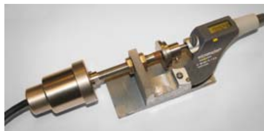
Рис. 3. Токовихревой датчик ИВД-2 и приспособление для калибровки измерения зазора
