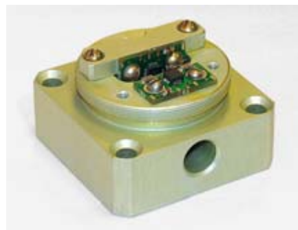
Рис. 2. Платы с чувствительными элементами в датчике ИВД-3
