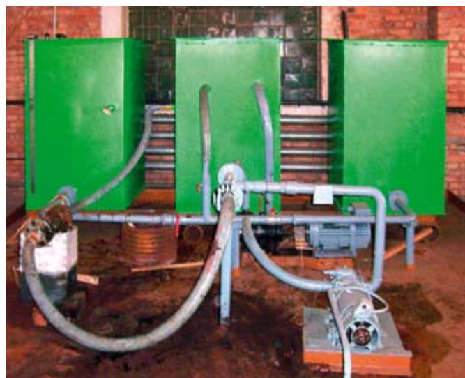
Рис. 6. Калибровочный стенд с подключённым измерителем
