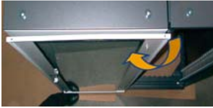
Рис. 15. Угол открывания дверей у соединённых в ряд шкафов 180°
