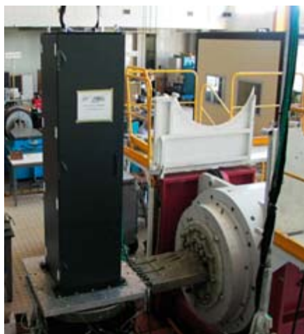
Рис. 4. Испытания шкафа на воздействие динамических нагрузок в лаборатории Soremea (Париж)
