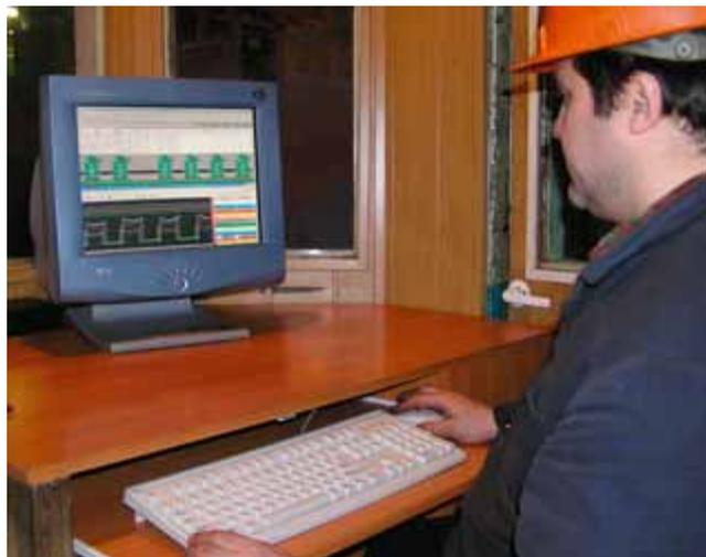
**Рис. 6. Рабочая станция дежурного по машинному залу непрерывной группы клетей 500**
