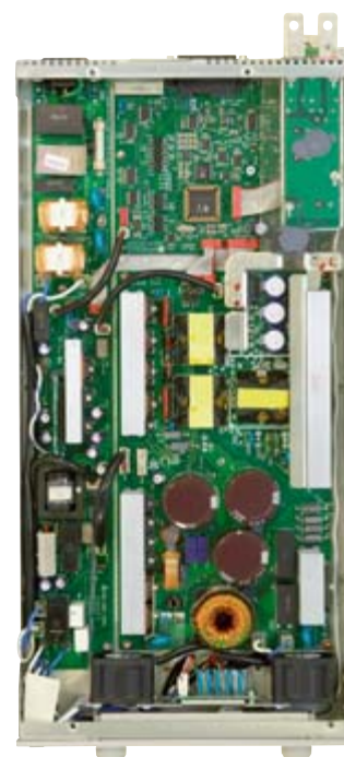
Рис. 9. Внешний вид конструкции программируемого ИВЭП GENH30-25 (вид сверху, защитная крышка снята)
