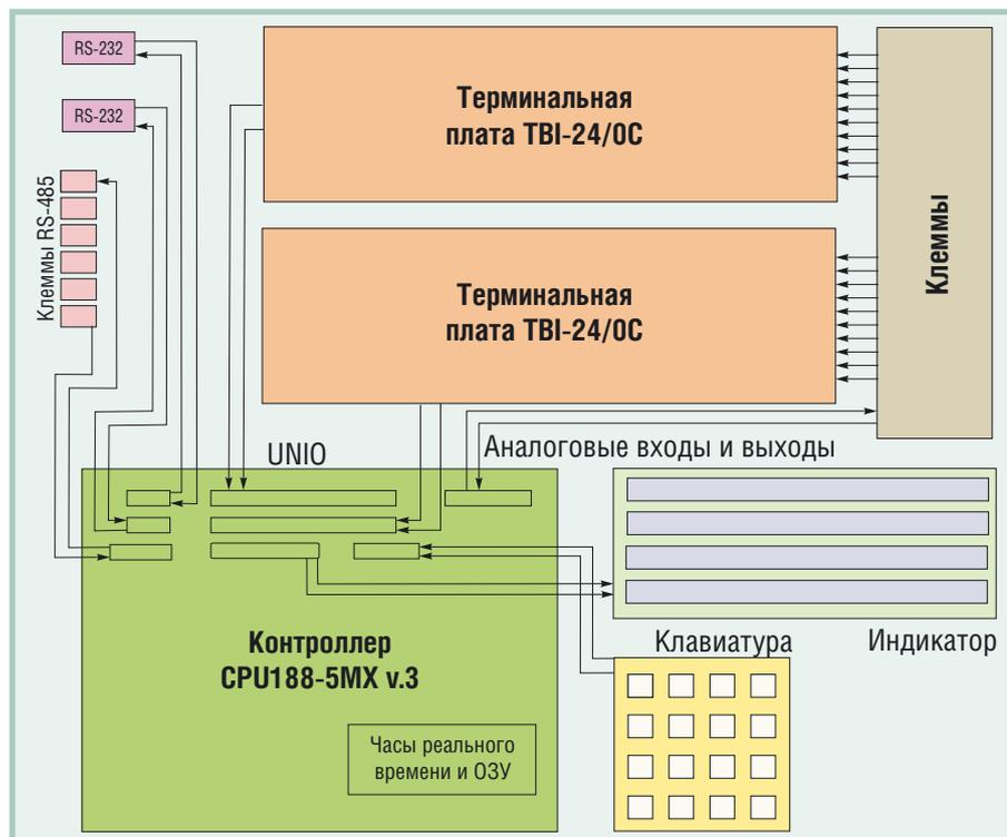
Рис. 1. Блок-схема аппаратной части периферийного устройства регистрации
