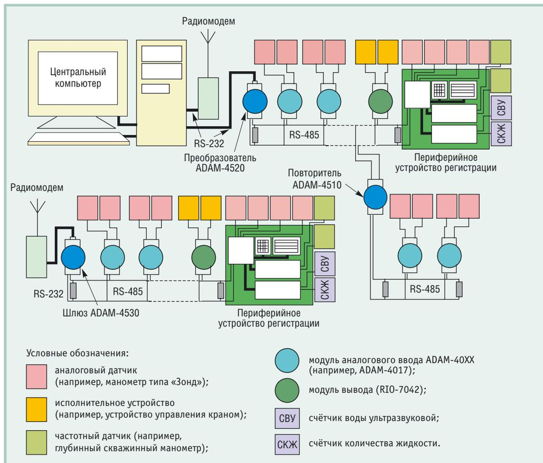
Рис. 2. Пример аппаратного комплекса системы регистрации данных
