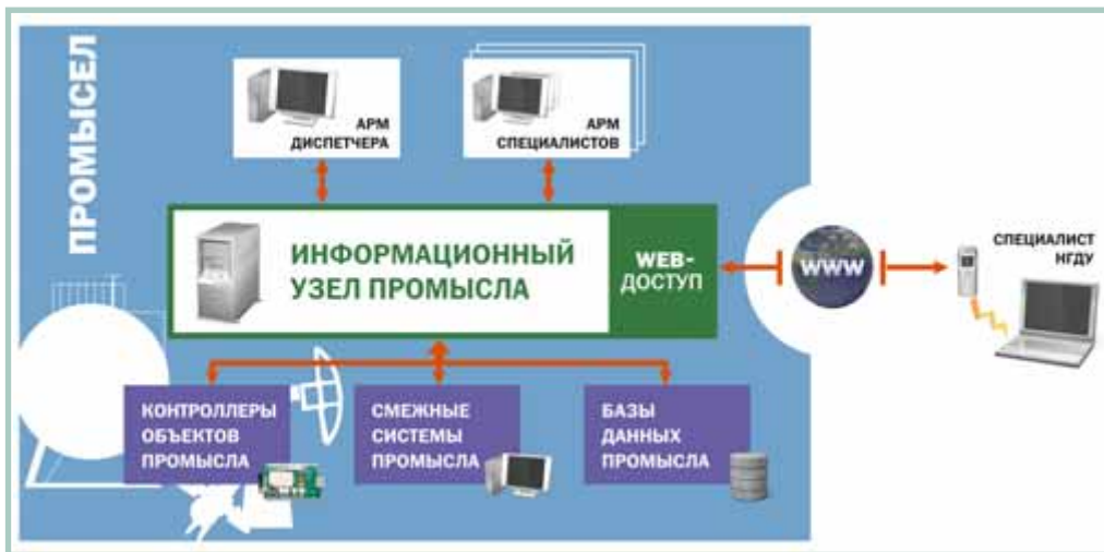
Рис. 2. Схема развёртывания системы «Мега» на промыслах
