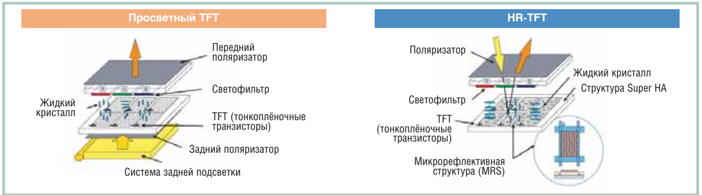
Рис. 3. Сравнение структур просветного TFT и отражательного HR-TFT ЖК-дисплеев
