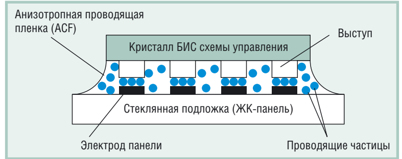
Рис. 12. Соединение ИМС управления и ячейки ЖК-дисплея по технологии COG
