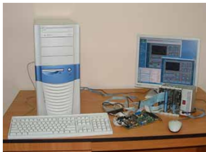
Рис. 5. «Сервер Octagon Systems» с модулем ввода-вывода Advantech PCL-812PG и контроллером MicroPC
