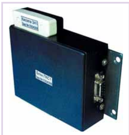
Рис. 5. Комплект бесконтактного энергонезависимого регистратора, состоящего из устройства коммутации (блок ПКС1) и накопителя (съёмная кассета ЭН1)
