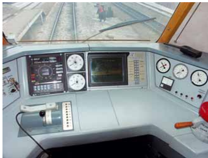
Рис. 11. Электролюминесцентный дисплей в кабине электровоза ВЛ80с
