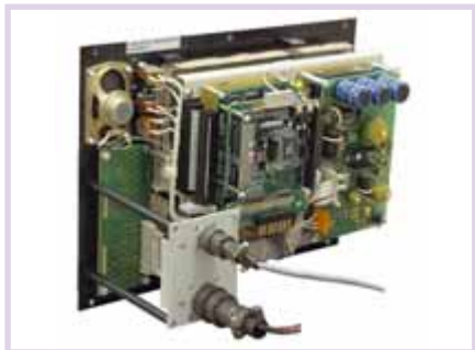
Рис. 9. Конструкция блока индикации с электролюминесцентным дисплеем на базе контроллера 6010 фирмы Octagon Systems
