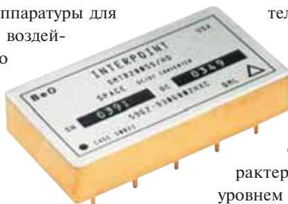
Рис. 3. Радиационно-стойкий DC/DC-преобразователь новой серии SMRT для космических применений
