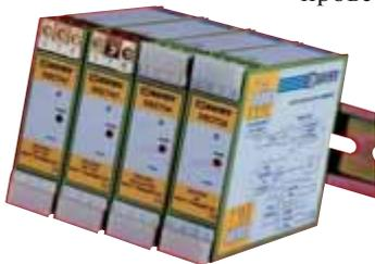
провести тонкую подстройку выходного диапазона и коррекцию значения нуля. Отличительными чертами модулей DSCT являются один диапазон выходного сигнала (к системе измерения), отсутствие модулей управления, более широкий по сравнению с модулями DSCA диапазон регулирования выходного диапазона и значения нуля, система питания модулей от источника токовой петли.
