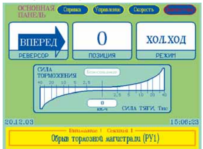
Рис. 11. Основная панель дисплея машиниста в режимах тяги и электродинамического тормоза с отображением аварийного сообщения
