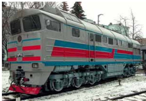
Рис. 1. Внешний вид тепловоза 2ТЭ116КМ-1135
