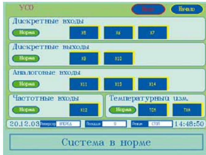
Рис. 13. Панель устройства связи с объектом
