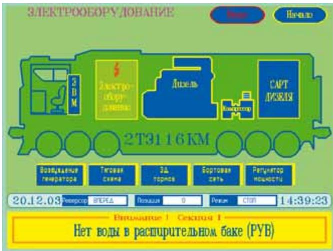
Рис. 12. Меню диагностических панелей с отображением аварийного сообщения
