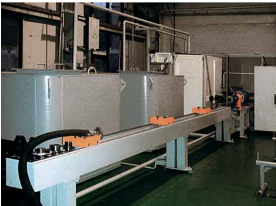
Рис. 1. Общий вид стенда тестирования погружного ЭЦН
