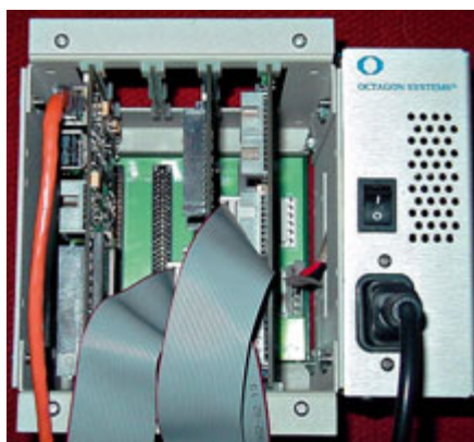
Рис. 2. Промышленный контроллер на базе процессорной платы Fastwel CPU686E
