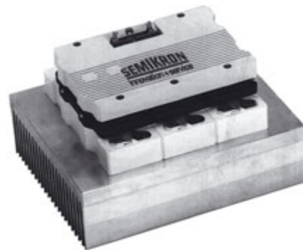
Рис. 6. Интегральная интеллектуальная силовая подсистема SKiiP
