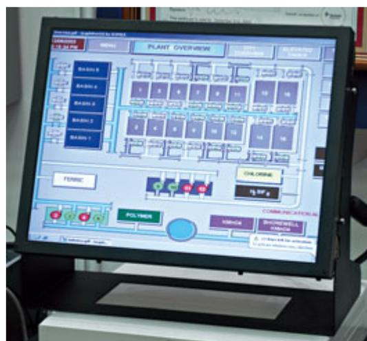
Рис. 1. Внешний вид ЖКД LC15.ANN.1000 с яркостью свечения 1000 кд/м<sup>2</sup>
