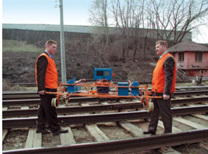
Рис. 2. Дефектоскоп АДС-02 на тестовых испытаниях
