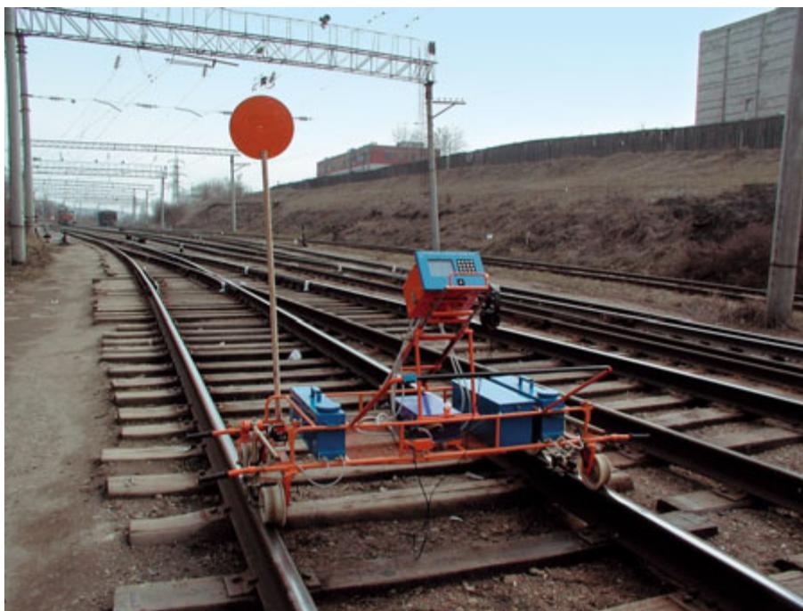
Рис. 1. Ультразвуковой съёмный рельсовый дефектоскоп АДС-02 в рабочем состоянии
