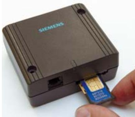
Рис. 2. Внешний вид модема MC35 Terminal
