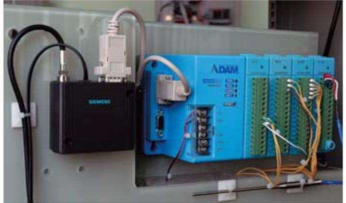
Рис. 4. Подключение модема MC35 Terminal к контроллеру ADAM-5000
