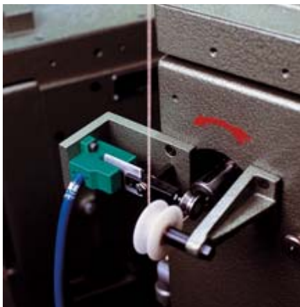
Рис. 29. Пример применения ИД щелевого типа для контроля натяжения нити
