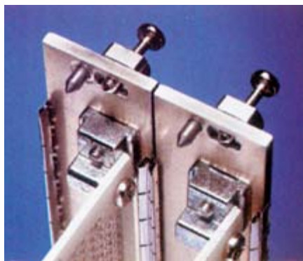
Рис. 5. Лицевые панели модулей и прокладка между ними
