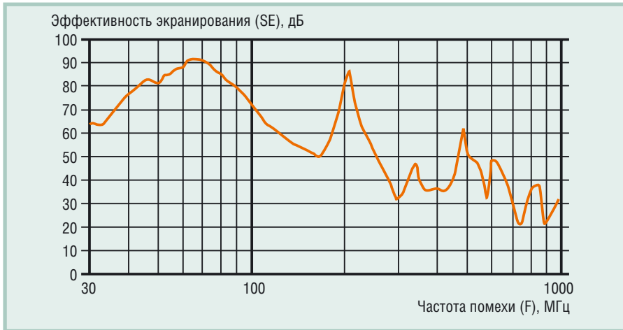
Рис. 12. Результаты испытаний субблока EuroсasPRO
