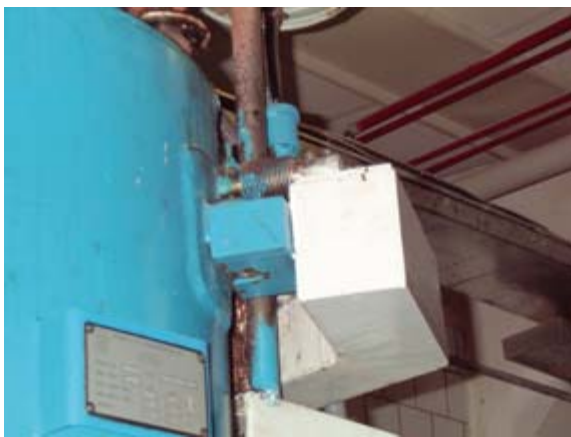
Рис. 9. Расположение тензодатчика весовой станции
