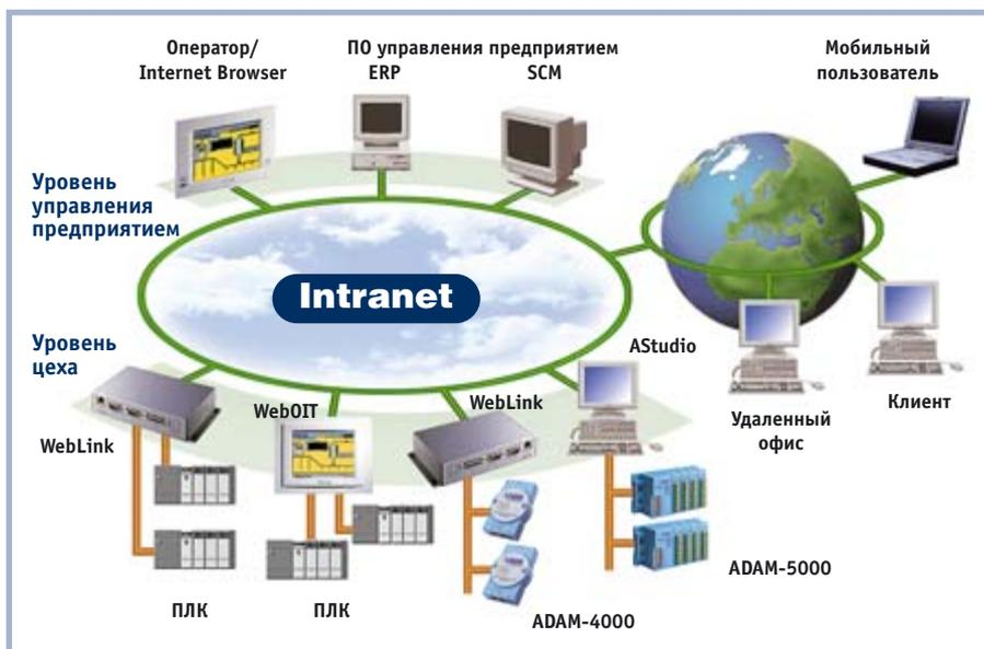
Рис. 1. Пример системы, демонстрирующей возможности концепции eAutomation
