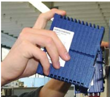
Рис. 1. Монтаж модуля серии Rail на DIN-рельс
