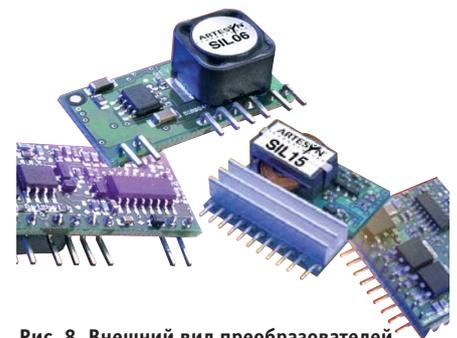
Рис. 8. Внешний вид преобразователей серий SIL06/SIL15
