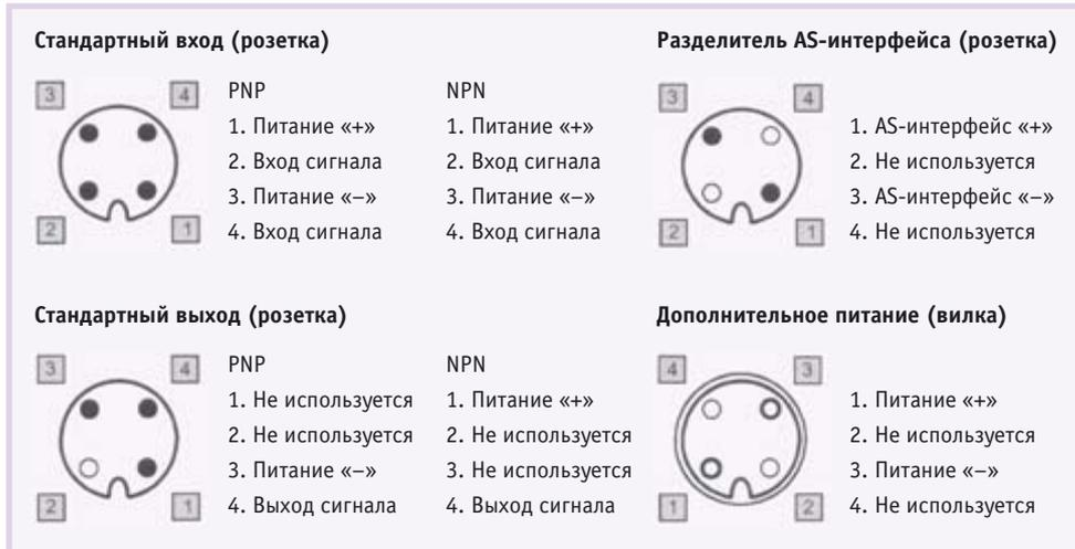
Рис. 8. Стандартизованное расположение контактов на разъёмах M12 модулей AS-интерфейса
