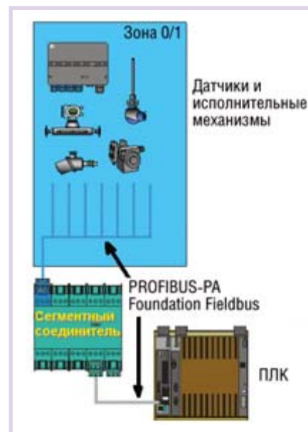
Рис. 7. Подключение оборудования взрывоопасной зоны через систему удалённого ввода-вывода
