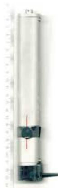
Рис. 2. Радиопередатчик РМ-Д
