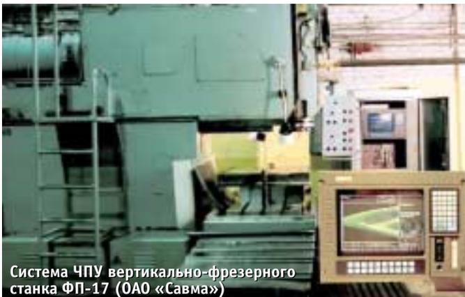
Система ЧПУ вертикально-фрезерного станка ФП-17 (ОАО «Савма»)
