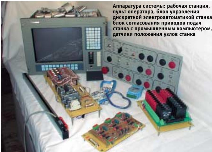
Аппаратура системы: рабочая станция, пульт оператора, блок управления дискретной электроавтоматики станка, блок согласования приводов подачи станка с промышленным компьютером, датчики положения узлов станка
