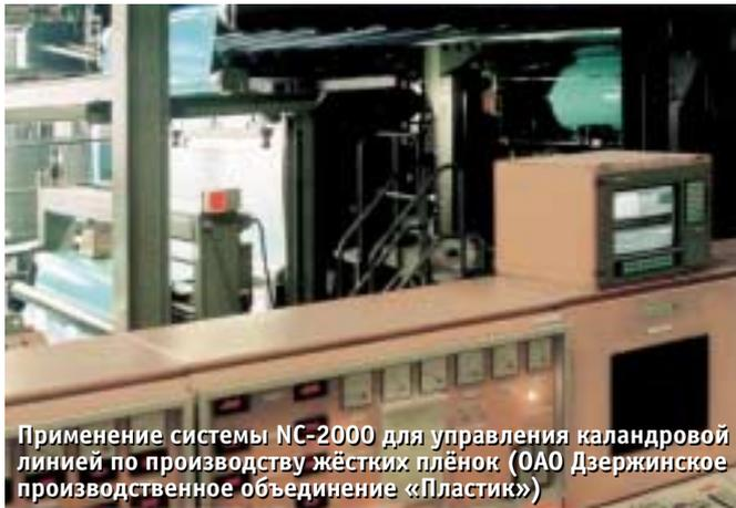
Применение системы NC-2000 для управления каландровой линией по производству жёстких плёнок (ОАО Дзержинское производственное объединение «Пластик»)
