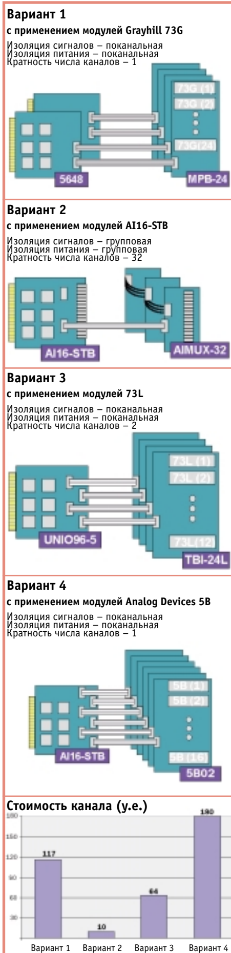
Рис. 19. Варианты реализации 96 изолированных аналоговых входов
