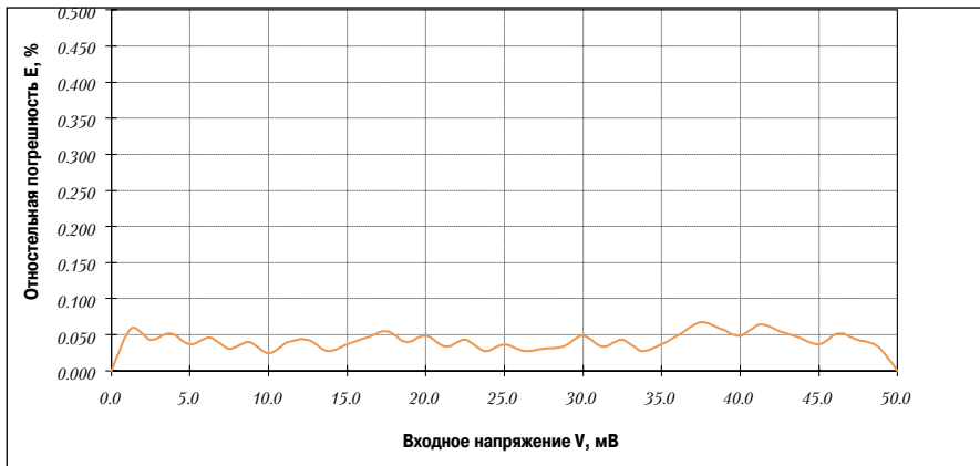
Рис. 12. Относительная погрешность измерения модуля аналогового ввода (в % от полной шкалы)
