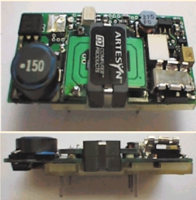
Рис. 2. Внешний вид бескорпусного преобразователя серии SXA10 с выходной мощностью 10 Вт. Габаритные размеры преобразователя 50,80x25,4x10 мм
