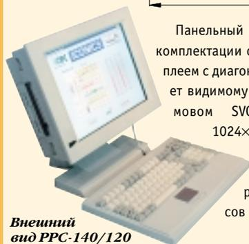
Панельный компьютер PPC-140 в стандартной комплектации оснащается плоским TFT ЖКИ-дисплеем с диагональю 13,8 дюйма (что соответствует видимому размеру изображения на 15-дюймовом SVGA-мониторе) и разрешением 1024×768 точек. Дисплей имеет широкий угол обзора в 120 градусов, яркость подсветки 250 кд/м и наработку на отказ (MTBF) 50000 часов (для подсветки — 25000 часов).
