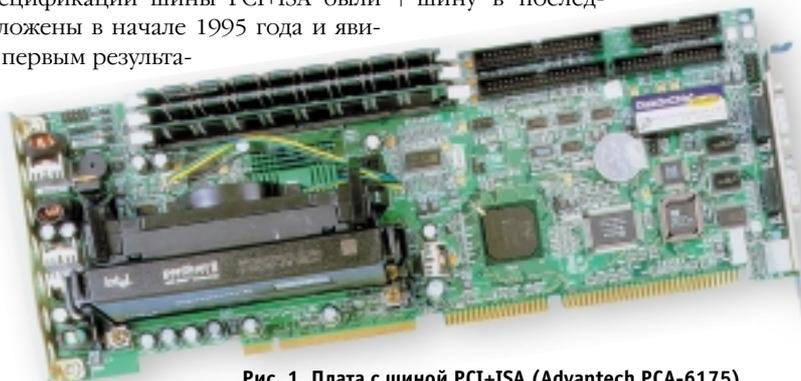
Рис. 1. Плата с шиной PCI+ISA (Advantech PCA-6175)
