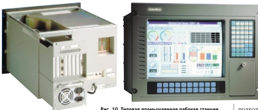
Рис. 10. Типовая промышленная рабочая станция (Advantech AWS-825)
