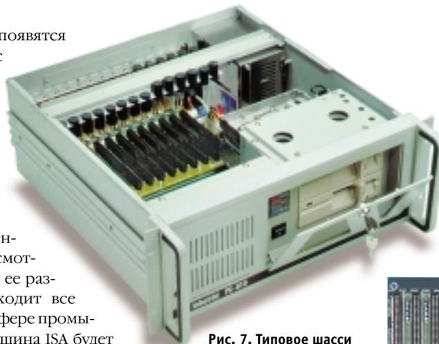
**Рис. 7. Типовое шасси промышленного компьютера (Advantech IPC-610)**
