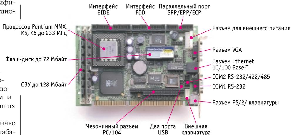
Рис. 6. Процессорная плата с шиной ISA (Advantech PCA-6154)
