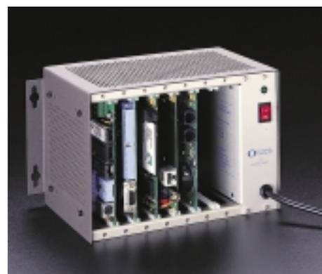
Рис. 12. MicroPC фирмы Octagon Systems
