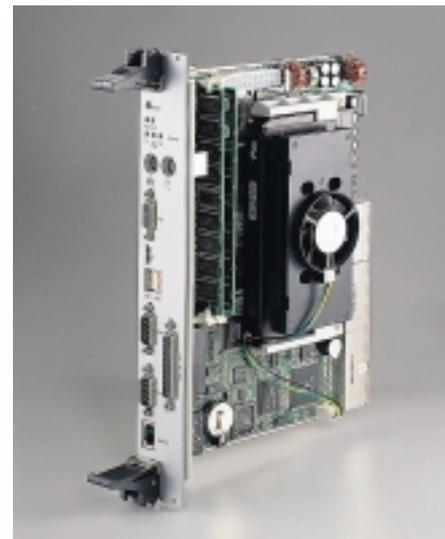
Рис. 2. Плата с шиной Compact PCI (Advantech MIC-3375)
