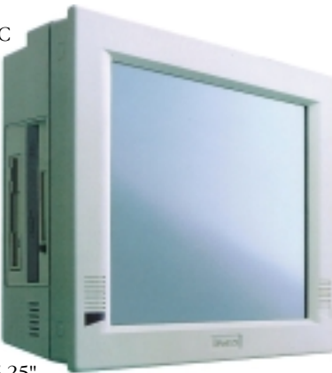
Панельный компьютер PPC-140 толщиной менее 10 см — это полнофункциональный ПК с быстродействием Pentium/MMX
