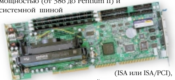
Высокопроизводительная процессорная плата PCA-6175 на базе Pentium II
