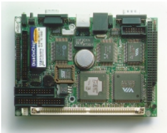
Одноплатный компьютер РСМ-4823 (5x86/133 МГц) с VGA, Ethernet и флэш-дискон
