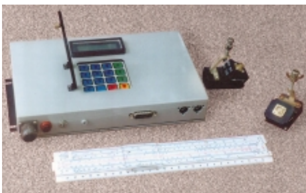
Рис. 5. Общий вид ультразвукового расходомера
