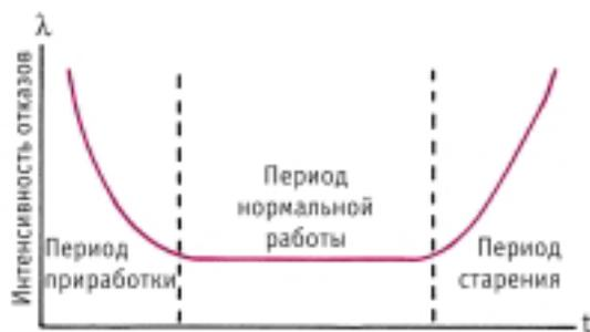
Рис. 7. Типичная зависимость интенсивности отказов от времени
