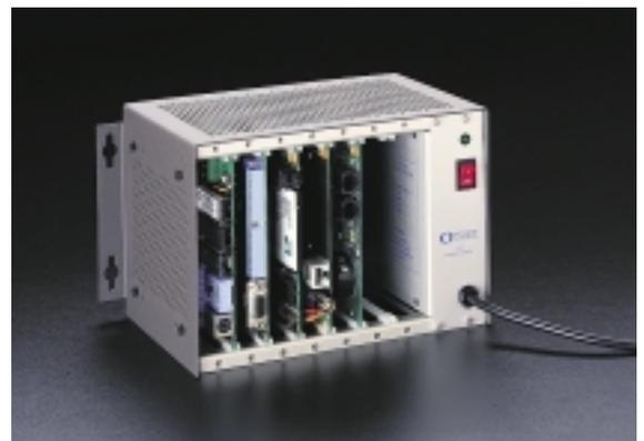
Рис. 3. Четырёхточечное крепление плат MicroPC в монтажном каркасе фирмы Octagon Systems обеспечивает повышенную вибростойкость и ударопрочность
