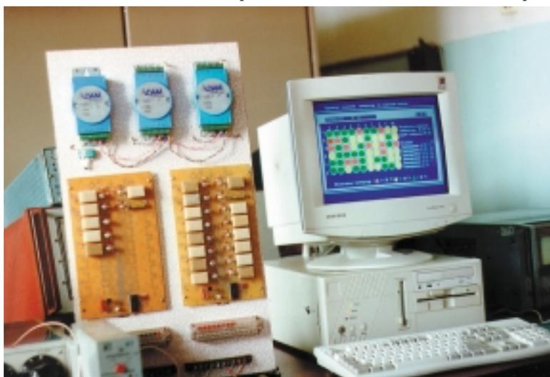
Рис. 2. Стенд для отработки технических решений системы контроля температур
