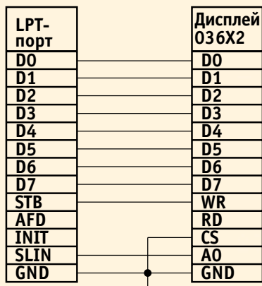
Рис. 5. Схема подключения дисплея к параллельному порту
