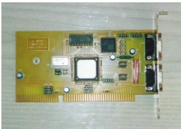
Рис. 7. Видеоконтроллер VC200
